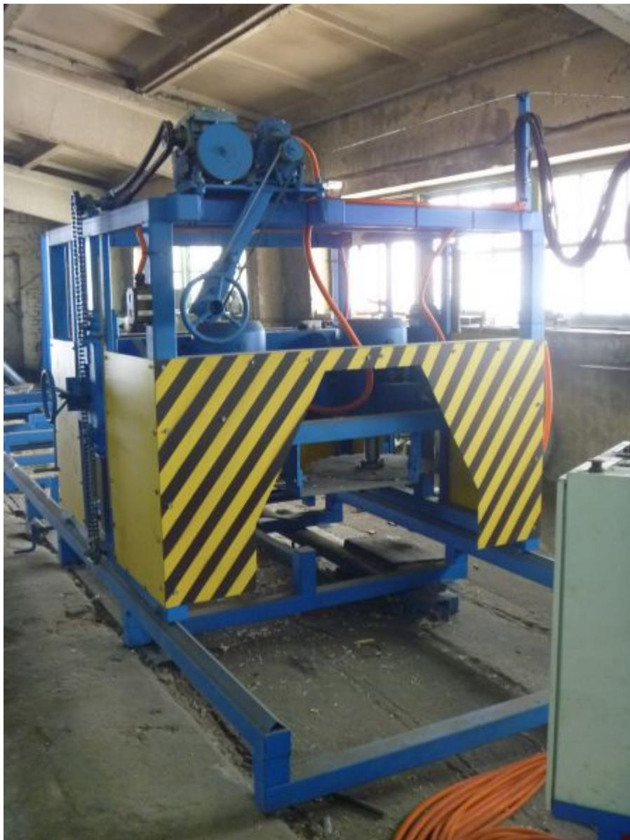
Дисковая горизонтальная пилорама Тойма 600 - надежный инструмент для получения пиломатериала с высокими характеристиками качества. Пилорама предназначена для продольной распиловки бревен различных пород. Станок отличается простой и в то же время продуманной конструкцией, высокой надежностью и производительностью.
